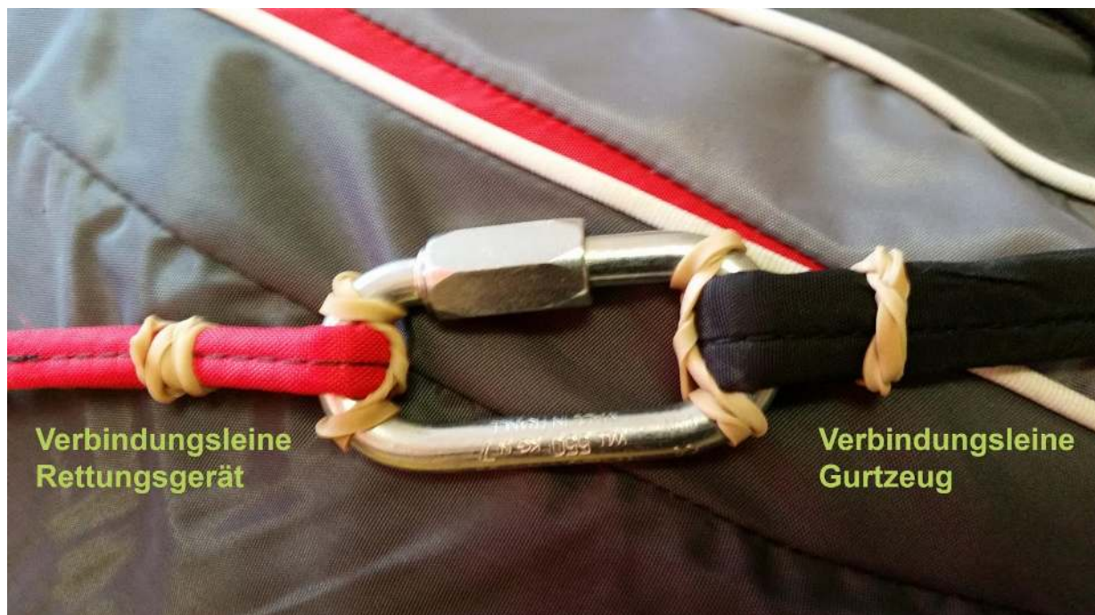
Das Bild oben zeigt die optimale Verbindung zwischen den zwei Verbindungsleinen (Schraubschäkellösung)
